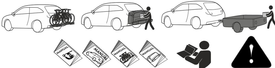
**ВНИМАНИЕ:** при использовании ТСУ для транспортировки багажной системы/багажник (велокрепление, мотоховост, автобокс, грузовая платформа) необходимо учитывать, что центр масс багажника смещен относительно оси шарового наконечника, что вызывает дополнительные нагрузки. Поэтому общая полная масса багажной системы (багажник + груз) не должна превышать значений, указанных в таблице;
